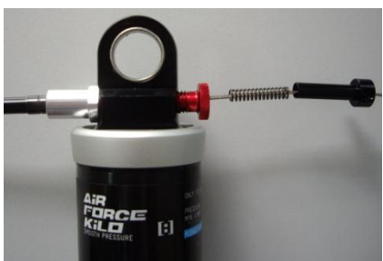
Pic. 16: Zug einfädeln
